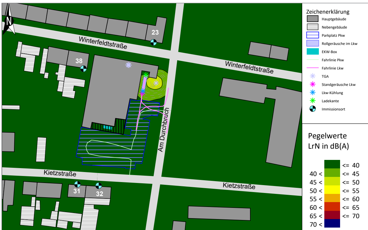
Abbildung 5-2 Isophonenkarte in 5 m Höhe über Gelände, Beurteilung nach TA Lärm, 22 - 6 Uhr
