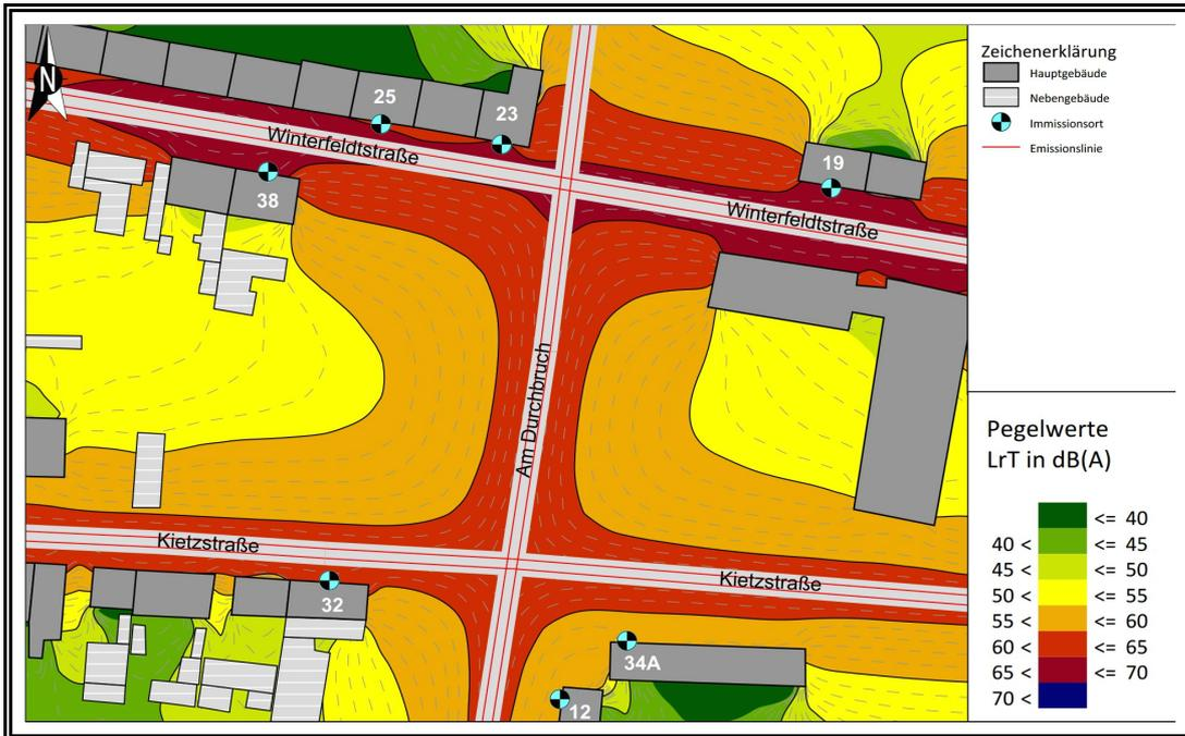
Abbildung 9: Isophonenkarte in 5 m Höhe über Gelände, Beurteilung nach DIN 18005, nachts (22 - 6 Uhr) - Nullfall
